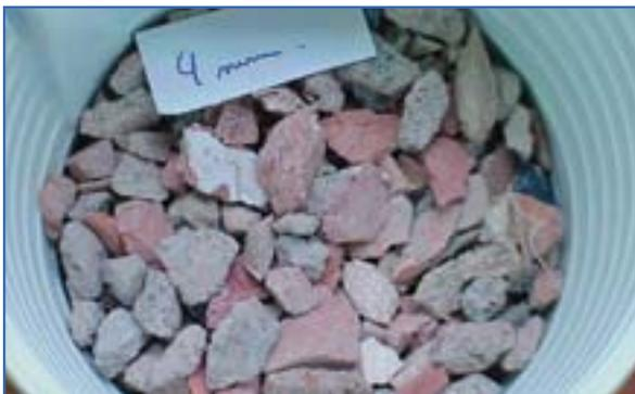
Fig 28: Árido reciclado Tipo 4A.
