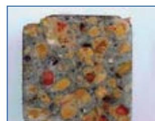
Fig 31: Aplicación de áridos reciclados Tipo 2 para la fabricación de hormigón estructural.
