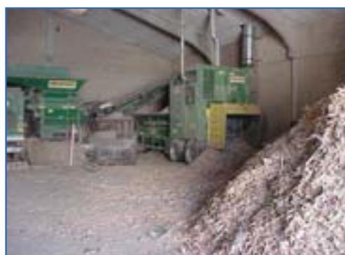
Fig. 33: Recogida y reciclaje de residuos de madera de demolición.
