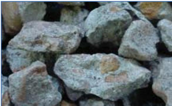
Fig 27: Árido reciclado Tipo 2.
