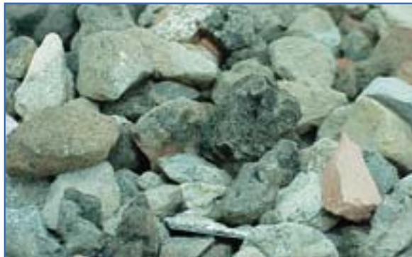
Fig 29: Árido reciclado Tipo 5.
