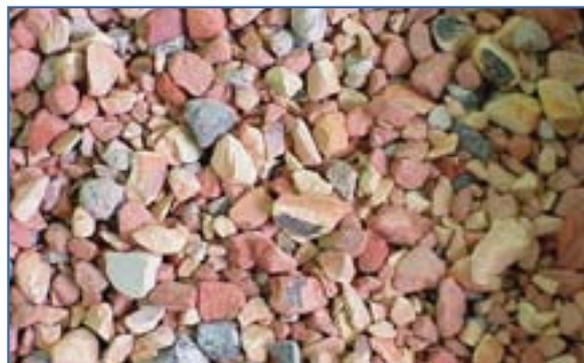
Fig 26: Árido reciclado Tipo 1.
